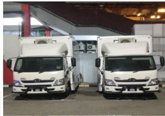
Stesen Bergerak GCMS (kiri) dan Stesen Bergerak GC-FID (kanan)
